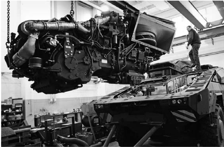
Im Materiallager Zeithain wird ein gepanzertes Transportfahrzeug für seinen Einsatz in Afghanistan vorbereitet. Triebwerkstausch durch Mitarbeiter der Firma Krauss-Maffei Wegmann. (Foto:BW / Mandt)
